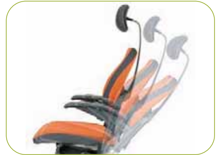
Synchronmechanik mit einem Öffnungswinkel von 98° bis 121,5°. Verhältnis 1:2,9.
