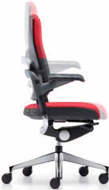
Die Kombination von Schiebesitz und schräggestelltem Rückenrahmen ermöglicht eine Sitztiefenverstellung von 10,7 cm. Der Höhenverstellbereich des Rückens beträgt 9 cm.
