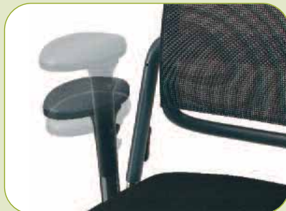
Die 3D-Multifunktions-Armlehne ist in der Höhe 11 cm verstellbar, die lichte Weite ist einstellbar von 36 bis 51 cm. Die Armauflagen sind exzentrisch gelagert und um 360° drehbar.
